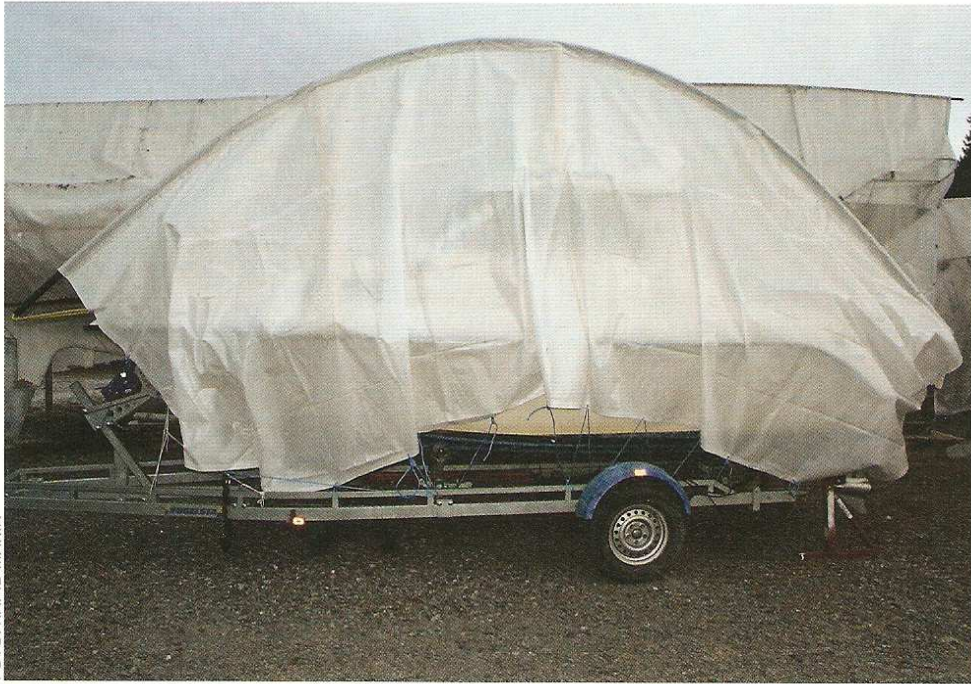
Rapid Marins täckställning, Easytec, fungerar bäst för båtar upp till nio meters längd. Enligt ställningens uppfinnare, Leif Olsson och Lars Kjellberg, går den att resa på en kvart.
